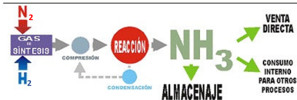
Imagen 19: Esquema proceso de Haber-Bosch. Fuente: Materiales virtuales ESPA LOE
