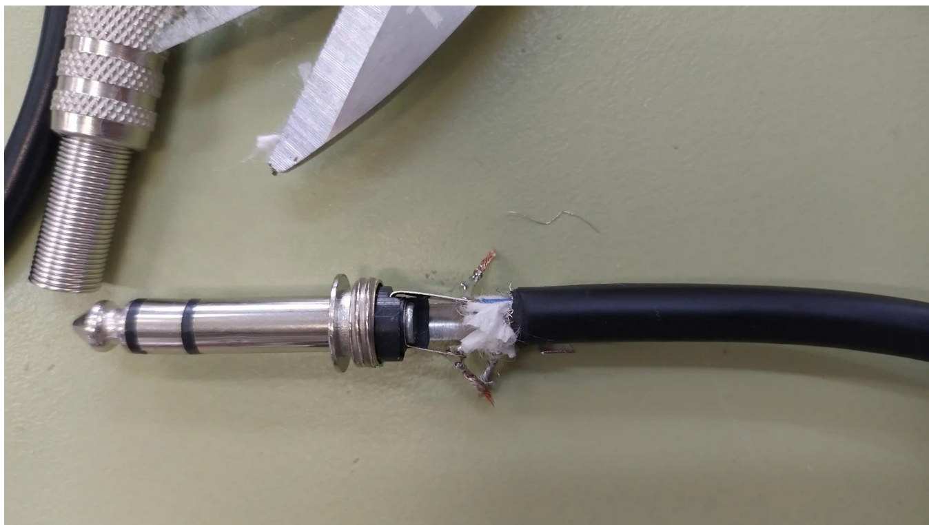
Foto 2: Los alumnos tuvieron que fabricar en el taller de un cable de audio para el distribuidor de auriculares
